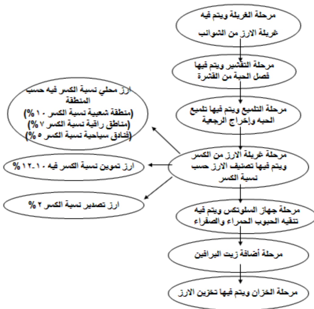
شكل رقم 1. مراحل تبيض الارز الشعير وتحويله الي ارز ابيض
